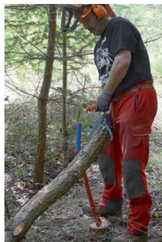
Eine weitere Möglichkeit, Schwachholz in eine günstige Arbeitshöhe zu bekommen, ist das Hochhängen mit Hilfe eines Fällhebers und einer Hebezange . Dazu wird nach der Fällung mit der Motorsäge ein senkrechter Stechschnitt in den verbleibenden Baumstumpf gesägt (Bild rechts). Der Schnitt muß in die Fällrichtung zeigen (Pfeil), damit der Fällheber beim Entasten nicht seitlich wegkippen kann. Der Fällheber wird in den gesägten Schnitt gesteckt, der gefällte Baum mit Hilfe einer Packzange angehoben und in den Fällheber eingehängt (oben).
