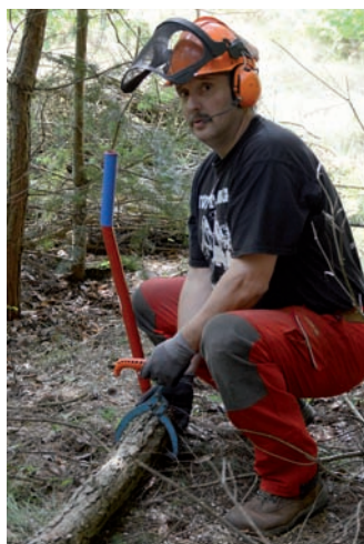
Eine weitere Möglichkeit, Schwachholz in eine günstige Arbeitshöhe zu bekommen, ist das Hochhängen mit Hilfe eines Fällhebers und einer Hebezange . Dazu wird nach der Fällung mit der Motorsäge ein senkrechter Stechschnitt in den verbleibenden Baumstumpf gesägt (Bild rechts). Der Schnitt muß in die Fällrichtung zeigen (Pfeil), damit der Fällheber beim Entasten nicht seitlich wegkippen kann. Der Fällheber wird in den gesägten Schnitt gesteckt, der gefällte Baum mit Hilfe einer Packzange angehoben und in den Fällheber eingehängt (oben).
