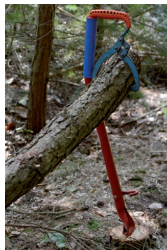
Eine weitere Möglichkeit, Schwachholz in eine günstige Arbeitshöhe zu bekommen, ist das Hochhängen mit Hilfe eines Fällhebers und einer Hebezange . Dazu wird nach der Fällung mit der Motorsäge ein senkrechter Stechschnitt in den verbleibenden Baumstumpf gesägt (Bild rechts). Der Schnitt muß in die Fällrichtung zeigen (Pfeil), damit der Fällheber beim Entasten nicht seitlich wegkippen kann. Der Fällheber wird in den gesägten Schnitt gesteckt, der gefällte Baum mit Hilfe einer Packzange angehoben und in den Fällheber eingehängt (oben).
