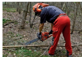
Liegt das Holz unterhalb der Kniehöhe (links), wird stets mit krummem Rücken gearbeitet. Das Hochhängen schwächerer Holzstämme zwischen Knie- und Hüfthöhe (rechts) sorgt für eine gerade Rückenposition. Fotos: B. Heinrich, KWF
