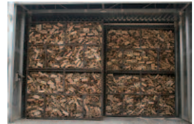
Oben: Trommel-trockner von S & Ü. Unten: In großen Gitterboxen trockenet das Scheitholz im „HTR 100“ von Hildebrand.
