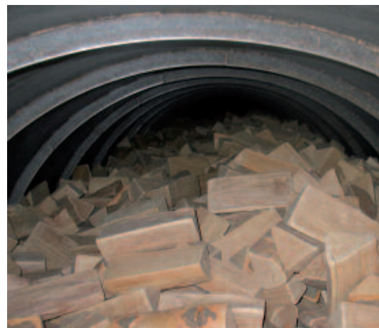
Trommeltrockner mit Innengewinde zum Ein- und Austragen des Scheitholzes.
